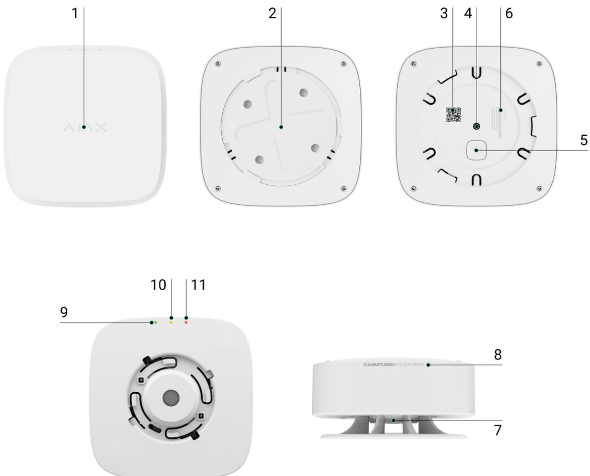
1. Передня панель датчика з кнопкою Тест/Глушіння. Щоб активувати кнопку, натисніть центральну частину панелі.
